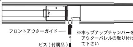
\*ホップアップチャンバーをビスが若干太い為、アウターバレルの取り付け穴を少し削って広げて下さい
